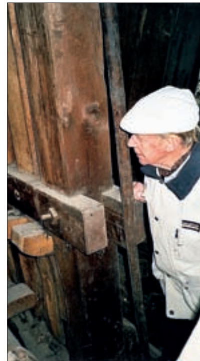
Josef Wimmer erklärt die Funktionsweise der Lederwalke, wo die Schießer von den Zapfen der Welle gehoben werden. Foto: F. Edlinger
